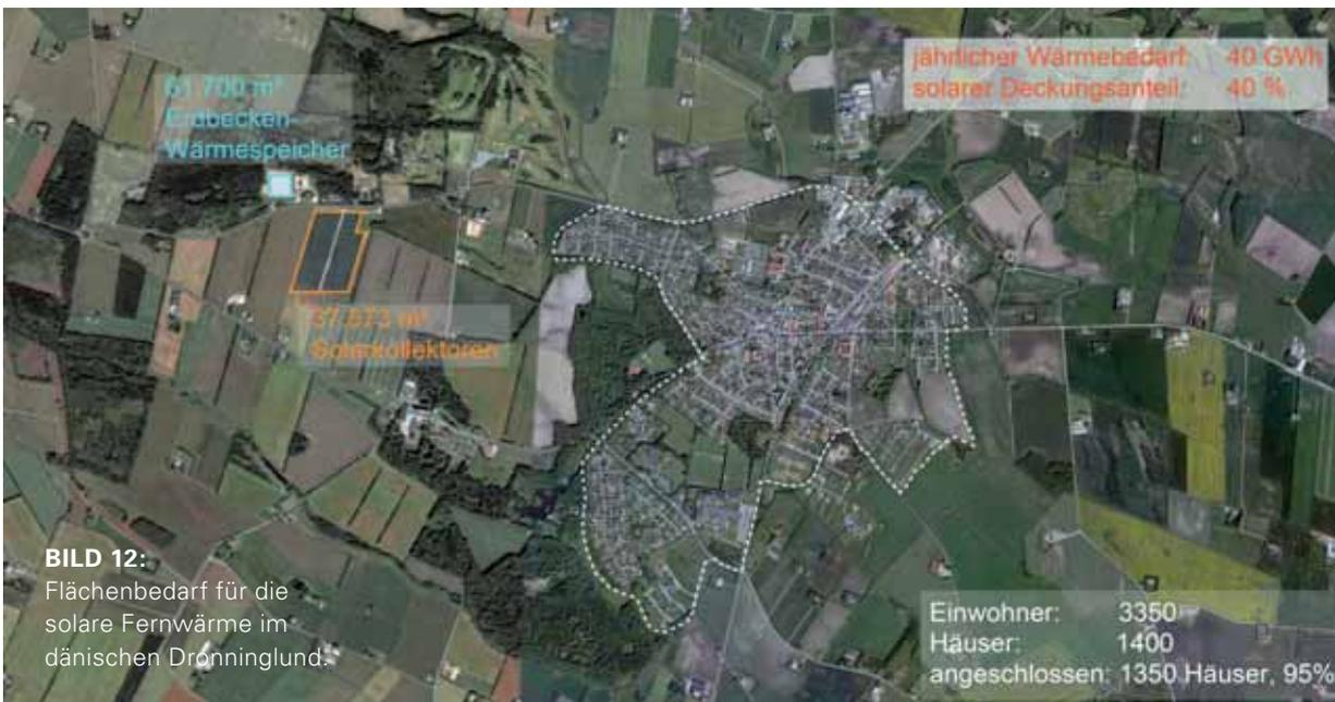
**BILD 12:** Flächenbedarf für die solare Fernwärme im dänischen Dronninglund.
